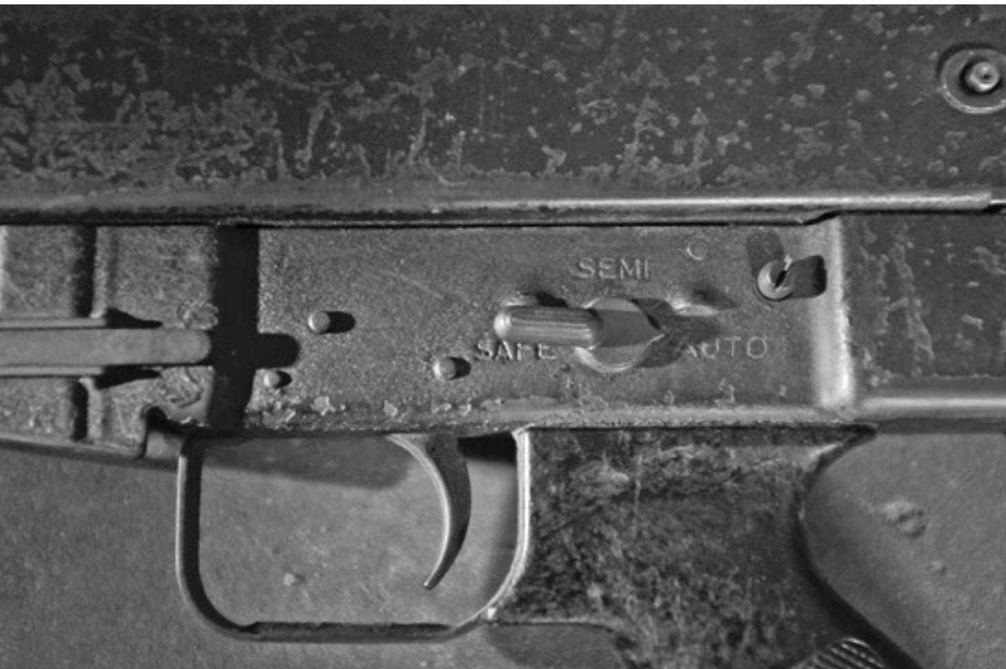
Mécanisme de sûreté sur un fusil d'assaut Colt M16A1 de calibre 5.56mm fabriqué aux Etats-Unis réglé en mode automatique.
