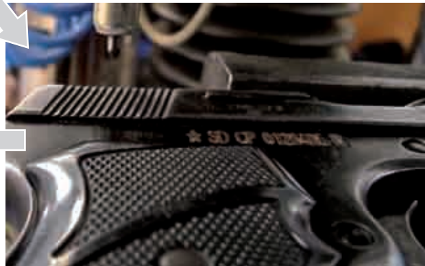
عملية الوسم: تقوم آلات النقر المجهري بنقر مجموعة من العلامات على جزء حيوي من السلاح لنقش أحرف وأرقام وصور يكون مجملها هوية مميزة لكل سلاح
